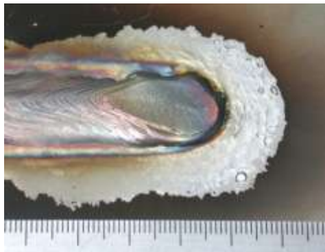
Figura 6.2 – Cordão de solda GMAW em aço inoxidável realizada com proteção de argônio puro mostrando a região de limpeza catódica na superfície da chapa.
