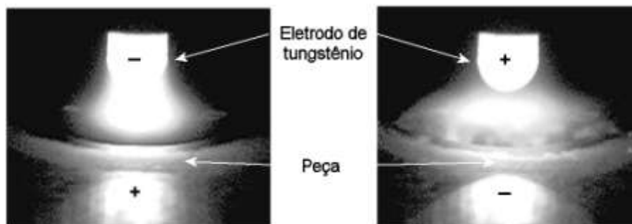
Figura 6.3 – Aspecto do arco na soldagem GTAW de alumínio com polaridade variável. Observar as “manchas catódicas” na superfície da peça na soldagem com eletrodo positivo (imagens extraídas de uma filmagem realizada no Laprosolda/UFU).
