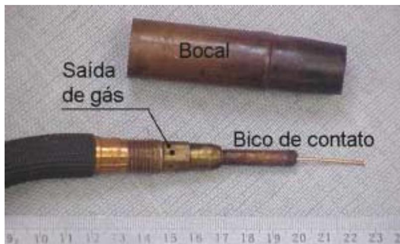
Figura 4 – Tocha para a soldagem GMAW semi-automática.
